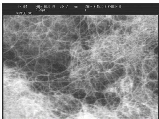
شکل ۱. تصویر SEM نانوتیوب‌های کربنی تک جداره
